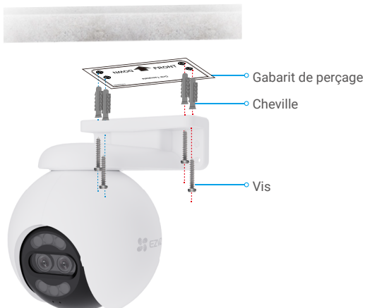
Fig. 1 Montage au plafond
